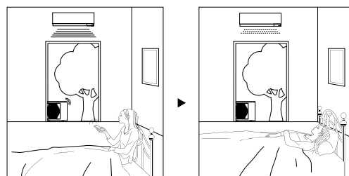
Nachtmodus: Reductie van het geluidsniveau van het buitendeel en led-deactivering op het binnendeel
